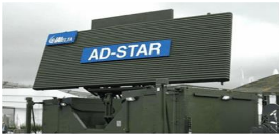
Radar EL/M-2288ER có phạm vi tìm kiếm mục tiêu xa với độ chính xác rất cao, đặc biệt là những mục tiêu nhỏ, tốc độ cao như tên lửa hành trình, tên lửa đạn đạo.
