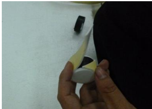
Bước 4: Sử dụng băng keo quấn quanh vật liệu xốp để giữ vật liệu xốp không bị lỏng ra khỏi hai nắp chai.
