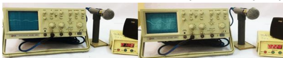
Hình 7. Dao động âm của loa điện động với độ cao khác nhau
