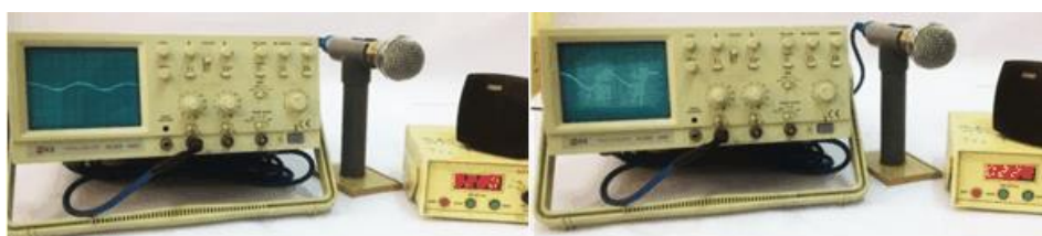
Hình 9. Dao động âm của loa điện động với độ to khác nhau
