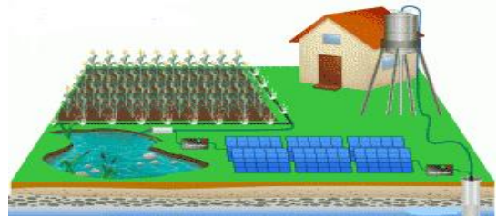
Hình 6. Mô hình thiết bị tưới nước cho cây cà phê sử dụng năng lượng mặt trời
