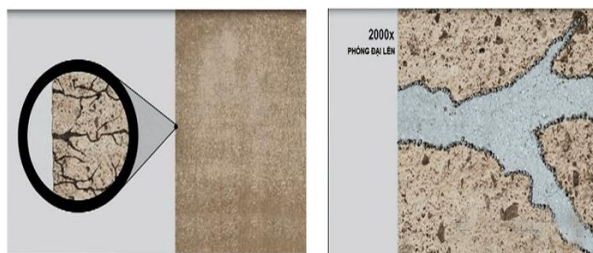
Bề mặt bê tông dưới kính hiển vi: có rất nhiều khe nứt
