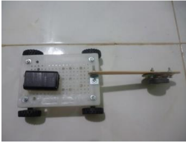
Hình 5. Mô hình xe hút đinh - nam châm vĩnh cửu
