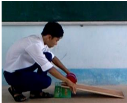
Hình 4. Đại diện nhóm 1, bố trí và tiến hành TN kiểm chứng momen quán tính của vật rắn phụ thuộc vào sự phân bố khối lượng đối với trục quay
