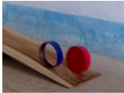
Hình 4. Đại diện nhóm 1, bố trí và tiến hành TN kiểm chứng momen quán tính của vật rắn phụ thuộc vào sự phân bố khối lượng đối với trục quay
