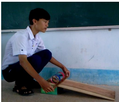
Hình 5. Đại diện nhóm 2, bố trí và tiến hành TN kiểm chứng momen quán tính của vật rắn phụ thuộc vào sự phân bố khối lượng đối với trục quay
