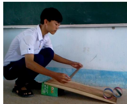
Hình 5. Đại diện nhóm 2, bố trí và tiến hành TN kiểm chứng momen quán tính của vật rắn phụ thuộc vào sự phân bố khối lượng đối với trục quay
