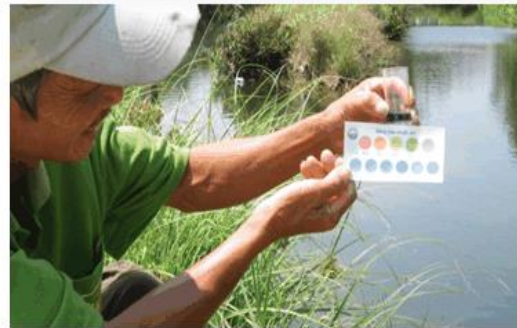
Hình 4. Nhóm cộng đồng nông cốt đang kiểm tra độ mặn (a) và pH (b) của môi trường nước mặt xã Cẩm Thanh
