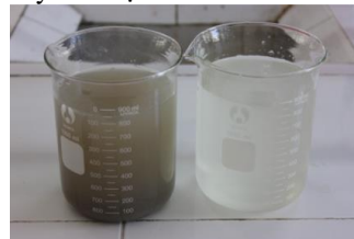
Hình 5. Mẫu nước thải thủy sản trước (bên trái) và sau (bên phải) khi xử lý bằng phương pháp keo tụ điện hóa
